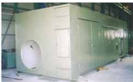
日立造船㈱向けGTGコージェネレーション設備 GTG cogeneration equipment for Hitachi Ship-building Co., Ltd
