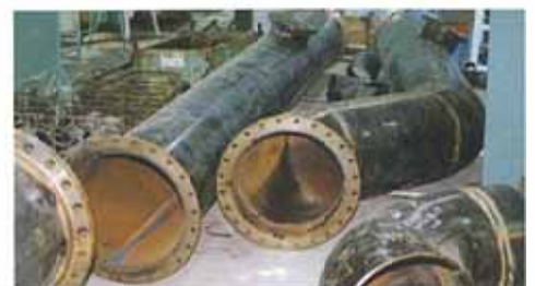
パイプ加工品 (大口径管) Prefabricated pipes (large-diameter)
