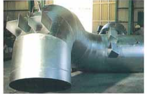
排ガス管 Exhaust gas piping
