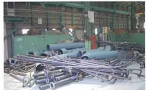
パイプ加工品 (小口径管) Prefabricated pipes (small-diameter)
